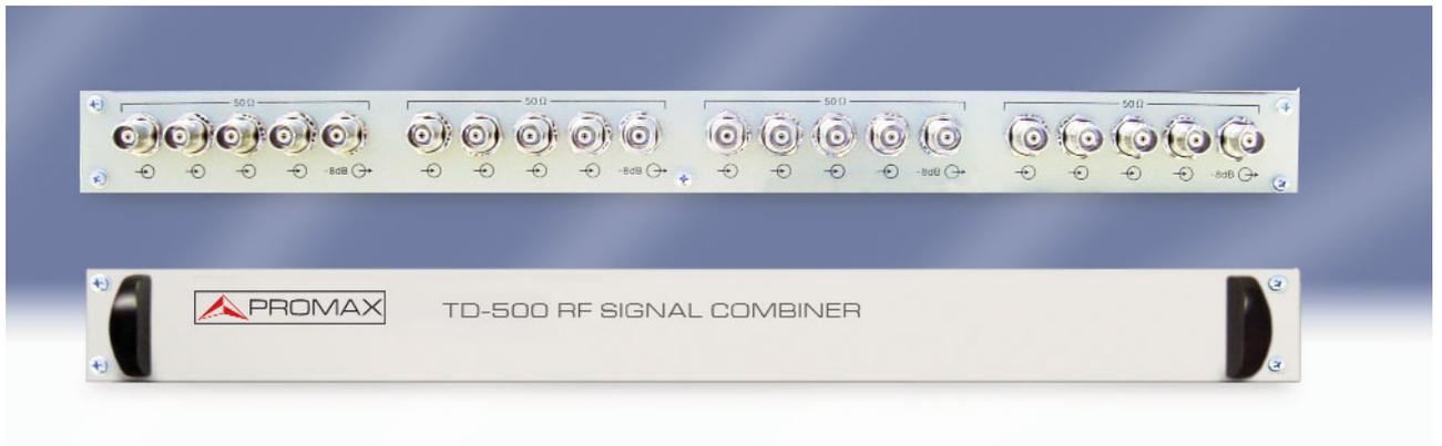
Der **TD-500** ist ein professionelles HF Sammelfeld / Verteiler im 19 Zoll breiten, 1U hohen Einbaugeschassis. Er bietet zwei identische Gruppen mit je 4 Eingängen auf einen Ausgang, die auch in entgegengesetzter Richtung nutzbar sind (1 Eingang gesplittet in 4 Ausgänge). Der Frequenzbereich reicht von 45 MHz bis 875 MHz und die durchschnittliche Eingangsdämpfung liegt bei:
