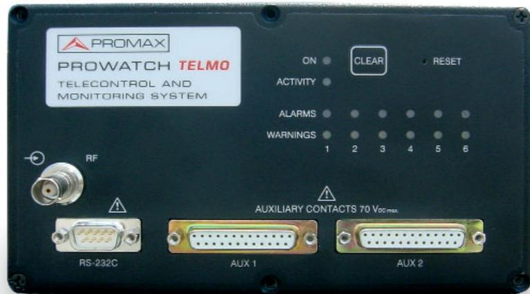
Das Basis-System **PROWATCH TELMO** wurde für die Fernsteuerung und Messung von digitalen terrestrischen Signalen (DVB-T) entwickelt. Das hauptsächliche Einsatzgebiet ist die Fernüberwachung der Signalqualität, Erzeugen von Alarmmeldungen wenn verschiedene Abweichungen auftreten, und allgemeine Überwachungsfunktionen in der Übertragungsstation, in der das Gerät installiert ist.
