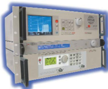
Falls ein bewegtes Bild benötigt wird, empfehlen wir den Testbildgenerator **GV-998** der einen Transport Strom zum ASI oder SPI Eingang liefert.
